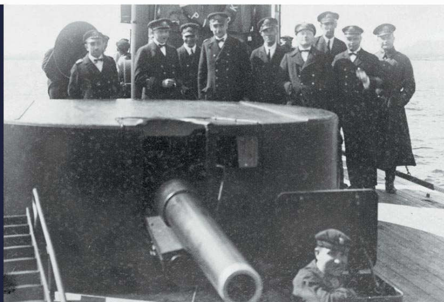
Artyleria główna monitora ORP „Pińsk” przed zmianą w 1930 r., francuska armata systemu Schneider wz. 1913 kalibru 105 mm. Ze zbiorów Muzeum Marynarki Wojennej w Gdyni.
